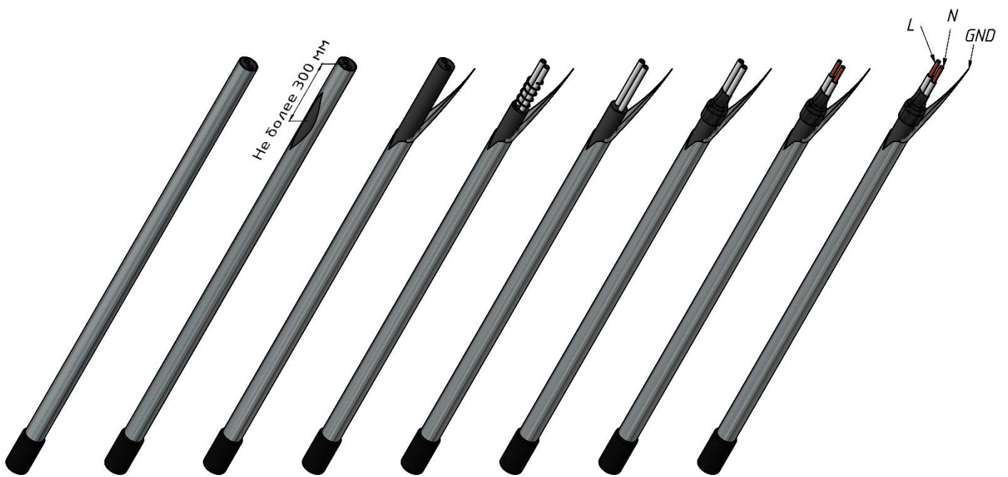
Рисунок 9. Подготовка отрезка ПЭНа к подключению
